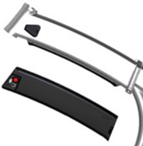
Batería Panasonic integrada al cuadro, desmontable.
