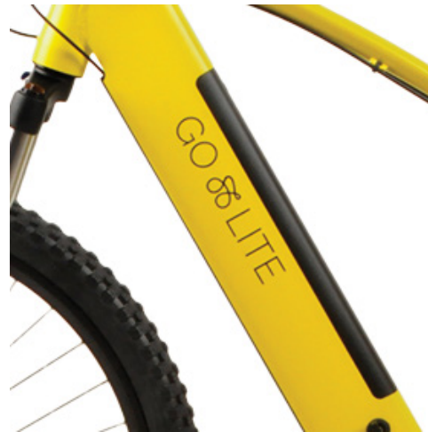
Batería Panasonic integrada al cuadro y desmontable.
