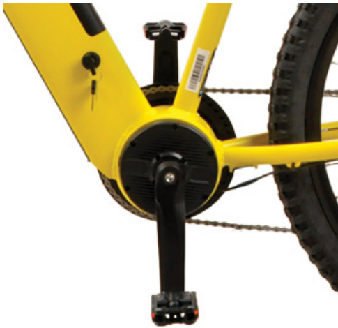
Motor uniaxial central con sensor de torque.
